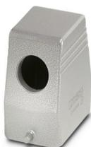
HEAVYCON Tüllengehäuse B6, für Längsbügel, Höhe 72 mm, mit Gewinde 1x M32, Leitungsabgang seitlich
