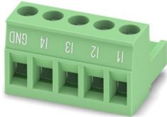
Leiterplattenstecker, Nennquerschnitt: 2,5 mm<sup>2</sup>, Farbe: weißgrün, Nennstrom: 12 A, Bemessungsspannung (III/2): 320 V, Kontaktoberfläche: Sn, Kontaktart: Buchse, Anzahl der Reihen: 1, Polzahl: 5, Artikelfamilie: BCP, Rastermaß: 5 mm, Anschlussart: Schraubanschluss mit Zughülse, Schraubenangriffsform: L Längsschlitz, Anschlussrichtung Leiter/Platine: 0 °, Rasthaken: - Rasthaken, Stecksystem: BASICLINE 2,5, Verriegelung: ohne, Befestigungsart: ohne, Verpackungsart: verpackt im Karton
