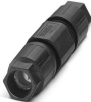
QUICKON-Leitungsverbinder, schwarz, 3+PE-polig, 0,75 mm<sup>2</sup> ... 1,5 mm<sup>2</sup> / 500 V / 15 A, für Kabeldurchmesser 6 mm ... 12 mm.
