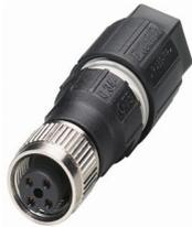
Steckverbinder, Universal, 4-polig, Buchse gerade M12, Kodierung: A, Schneidklemmanschluss, Rändelmaterial: Zinkdruckguss, vernickelt, Leitungsaußendurchmesser 4 mm ... 8 mm
