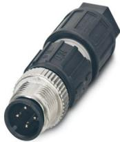
Steckverbinder, Universal, 4-polig, Stecker gerade M12, Kodierung: A, Schneidklemmanschluss, Rändelmaterial: Zinkdruckguss, vernickelt, Leitungsaußendurchmesser 3,5 mm ... 6 mm
