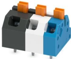
Leiterplattenklemme, Nennstrom: 16 A, Bemessungsspannung (III/2): 320 V, Nennquerschnitt: 1,5 mm<sup>2</sup>, Anzahl der Reihen: 1, Polzahl pro Reihe: 3, Artikelfamilie: SPTAF 1/..-EL, Rastermaß: 5 mm, Anschlussart: Push-in-Federanschluss, Montage: Wellenlöten, Anschlussrichtung Leiter/Platine: 45 °, Farbe: mehrfarbig, Pin-Layout: Lineares Pinning, Pinlänge [P]: 2,6 mm, Anzahl der Lötpins pro Potenzial: 2, Verpackungsart: verpackt im Karton
