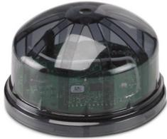
Zhaga-Book-18 kompatibles Steuergerät für Straßenleuchten über LoRaWAN®, VPE: 48 Stück, Spannungsversorgung und DALI-2 Kommunikation über Zhaga kompatible Sockel, Ansteuerung DALI-2 kompatibler EVGs
