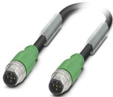
Sensor-/Aktor-Kabel, 5-polig, PUR halogenfrei, schwarzgrau RAL 7021, geschirmt, Stecker gerade M12, Kodierung: A, auf Stecker gerade M12, Kodierung: A, Kabellänge: 2 m
