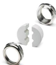
HEAVYCON M50 Kabelschraubung Metall, Wanddurchführung für Datenstecker, mit teilbarer Dichtung, 2 x 9 mm Lochdurchmesser; Lichte Weite 42mm
