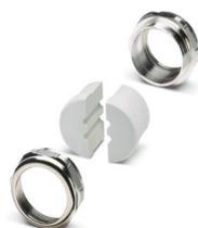
HEAVYCON M50 Kabelschraubung Metall, Wanddurchführung für Datenstecker, mit teilbarer Dichtung, 2 x 6 mm Lochdurchmesser; Lichte Weite 37mm
