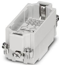
Kontakteinsatz, Polzahl: 6+36+PE, Baugröße: B16, Leistungskontakte: 6, Steuerkontakte: 36, Stift, Crimpanschluss, 690 V, 40 A, 1,5 mm<sup>2</sup> ... 6 mm<sup>2</sup>, Anwendung: Leistung/Signal
