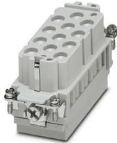
Kontakteinsatz, Polzahl: 12+2+PE, Baugröße: B16, Leistungskontakte: 12, Steuerkontakte: 2, Buchse, Crimpanschluss, 690 V, 40 A, 1,5 mm<sup>2</sup> ... 6 mm<sup>2</sup>, Anwendung: Leistung/Signal
