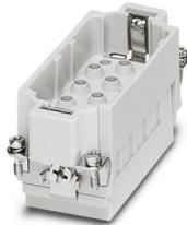
Kontakteinsatz, Polzahl: 12+2+PE, Baugröße: B16, Leistungskontakte: 12, Steuerkontakte: 2, Stift, Crimpanschluss, 690 V, 40 A, 1,5 mm<sup>2</sup> ... 6 mm<sup>2</sup>, Anwendung: Leistung/Signal
