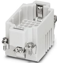
Kontakteinsatz, Polzahl: 8+24+PE, Baugröße: B10, Leistungskontakte: 8, Steuerkontakte: 24, Stift, Crimpanschluss, 230 V, 16 A, 0,5 mm<sup>2</sup> ... 4 mm<sup>2</sup>, Anwendung: Leistung/Signal
