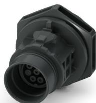
Gerätesteckverbinder Vorderwand, Artikelfamilie: PRC 20, Bauform: gerade, Farbe: schwarz, Polzahl: 6, Aderquerschnitt min.: 0,75 mm<sup>2</sup>, Aderquerschnitt max.: 1 mm<sup>2</sup>, Bemessungsspannung: Dreiphasig 630 V AC, Bemessungsstrom: 8 A, Anschlussart: Crimpanschluss, Kabeldurchmesser min.: 6 mm, Kabeldurchmesser max.: 14 mm, Einstellmöglichkeit für die Entriegelung: 1. mit einem Werkzeug oder 2. von Hand
