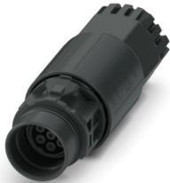
Kupplungssteckverbinder, Artikelfamilie: PRC 20, Bauform: gerade, Farbe: schwarz, Polzahl: 7, Aderquerschnitt min.: 0,75 mm<sup>2</sup>, Aderquerschnitt max.: 1 mm<sup>2</sup>, Bemessungsspannung: Dreiphasig 630 V AC, Bemessungsstrom: 8,5 A, Anschlussart: Crimpanschluss, Kabeldurchmesser min.: 6 mm, Kabeldurchmesser max.: 14 mm, Einstellmöglichkeit für die Entriegelung: 1. mit einem Werkzeug oder 2. von Hand
