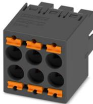
Leiterplattenstecker, Nennquerschnitt: 1,5 mm<sup>2</sup>, Farbe: schwarz, Nennstrom: 8 A, Bemessungsspannung (III/2): 320 V, Kontaktoberfläche: Sn, Kontaktart: Buchse, Anzahl der Potenziale: 6, Anzahl der Reihen: 2, Polzahl: 6, Anzahl der Anschlüsse: 6, Rastermaß: 5,08 mm, Anschlussart: Push-in-Federanschluss, Anschlussrichtung Leiter/Platine: 0 °, Rasthaken: - Rasthaken, Stecksystem: HSC 1,5, Verriegelung: ohne, Befestigungsart: ohne, Verpackungsart: verpackt im Karton
