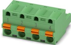
Leiterplattenstecker, Nennquerschnitt: 2,5 mm<sup>2</sup>, Farbe: grün, Nennstrom: 12 A, Bemessungsspannung (III/2): 630 V, Kontaktoberfläche: Sn, Kontaktart: Buchse, Anzahl der Reihen: 1, Polzahl: 4, Artikelfamilie: GFKC 2,5/..-ST, Rastermaß: 7,62 mm, Anschlussart: Push-in-Federanschluss, Anschlussrichtung Leiter/Platine: 0 °, Rasthaken: - Rasthaken, Stecksystem: COMBICON MSTB 2,5, Verriegelung: ohne, Befestigungsart: ohne, Verpackungsart: verpackt im Karton
