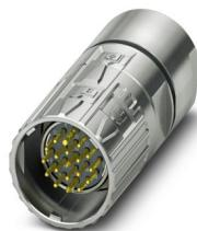
M23, Kabelsteckverbinder, Serie: M23 PRO, gerade, geschirmt: ja, ONECLICK-Schnellverriegelung, Polzahl: 16+2+PE, Drehsinn: Standard, Kontaktart: Stift, Crimpanschluss, Kabeldurchmesserbereich: 4 mm ... 8,5 mm, Kodierung: N, Artikel ist bleifrei nach RoHS II ohne Ausnahme 6c ( $Pb < 0,1\%$ )
