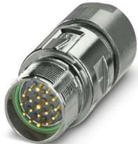
M23, Kupplungssteckverbinder, Serie: M23 PRO, gerade, geschirmt: ja, für Standard- und ONECLICK-Schnellverriegelung, Polzahl: 16+2+PE, Drehsinn: Standard, Kontaktart: Stift, Crimpanschluss, Kabeldurchmesserbereich: 3 mm ... 15 mm, Kodierung: N, Artikel ist bleifrei nach RoHS II ohne Ausnahme 6c (Pb < 0,1 %)
