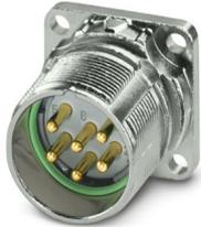
M23, Gerätesteckverbinder Vorderwand, Serie: M23 PRO Signal, gerade, geschirmt: ja, für Standard- und ONECLICK-Schnellverriegelung, Polzahl: 6, Drehsinn: Standard, Kontaktart: Stift, Crimpanschluss, Flanschmaß: 26 mm x 26 mm, Kodierung: N, Artikel ist bleifrei nach RoHS II ohne Ausnahme 6c (Pb < 0,1 %)
