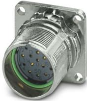
M23, Gerätesteckverbinder Vorderwand, Serie: M23 PRO, gerade, geschirmt: ja, für Standard- und ONECLICK-Schnellverriegelung, Polzahl: 17, Drehsinn: Standard, Kontaktart: Buchse, Crimpanschluss, Flanschmaß: 28 mm x 28 mm, Kodierung: N, Artikel ist bleifrei nach RoHS II ohne Ausnahme 6c (Pb < 0,1 %)
