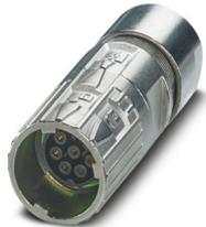
M17, Kabelsteckverbinder, Serie: M17 PRO, gerade, geschirmt: ja, ONECLICK-Schnellverriegelung, Polzahl: 7+PE, Kontaktart: Buchse, Crimpanschluss, Kabeldurchmesserbereich: 8,5 mm ... 12 mm, Artikel ist bleifrei nach RoHS II ohne Ausnahme 6c (Pb < 0,1 %)
