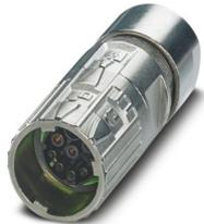
M17, Kabelsteckverbinder, Serie: M17 PRO, gerade, geschirmt: ja, ONECLICK-Schnellverriegelung, Polzahl: 5+3+PE, Kontaktart: Buchse, Crimpanschluss, Kabeldurchmesserbereich: 3,5 mm ... 6,5 mm, Artikel ist bleifrei nach RoHS II ohne Ausnahme 6c (Pb < 0,1 %)
