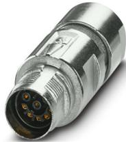
M17, Kupplungssteckverbinder, Serie: M17 PRO, gerade, geschirmt: ja, für Standard- und ONECLICK-Schnellverriegelung, Polzahl: 8, Kontaktart: Buchse, Crimpanschluss, Kabeldurchmesserbereich: 3,5 mm ... 6,5 mm, Artikel ist bleifrei nach RoHS II ohne Ausnahme 6c (Pb < 0,1 %)
