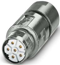
M23, Kupplungssteckverbinder, Serie: M23 PRO, gerade, geschirmt: ja, für Standard- und ONECLICK-Schnellverriegelung, Polzahl: 5+PE, Kontaktart: Buchse, Crimpanschluss, Kabeldurchmesserbereich: 7,5 mm ... 17 mm, Kodierung: N, Artikel ist bleifrei nach RoHS II ohne Ausnahme 6c (Pb < 0,1 %)
