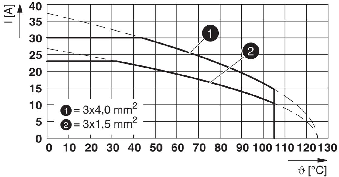
I = Stromstärke,  $\vartheta$  = Umgebungstemperatur, 3 x 30 A (Kurve 1), 3 x 24 A (Kurve 2)
