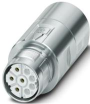
M23, Kupplungssteckverbinder, Serie: M23 PRO, gerade, geschirmt: ja, für Standard- und ONECLICK-Schnellverriegelung, Polzahl: 4+3+PE, Drehsinn: Standard, Kontaktart: Buchse, Crimpanschluss, Kabeldurchmesserbereich: 7,5 mm ... 17 mm, Kodierung: N, Artikel ist bleifrei nach RoHS II ohne Ausnahme 6c (Pb < 0,1 %)
