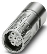
M23, Kabelsteckverbinder, Serie: M23 PRO, gerade lang, geschirmt: ja, ONECLICK-Schnellverriegelung, Polzahl: 4+3+PE, Kontaktart: Buchse, Crimpanschluss, Kabeldurchmesserbereich: 5,5 mm ... 8 mm, Kodierung: N, Artikel ist bleifrei nach RoHS II ohne Ausnahme 6c (Pb < 0,1 %)
