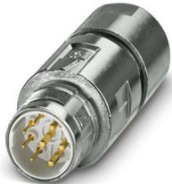
M23, Kupplungssteckverbinder, Serie: M23 PRO, gerade, geschirmt: ja, für Standard- und ONECLICK-Schnellverriegelung, Polzahl: 4+3+PE, Kontaktart: Stift, Crimpanschluss, Kabeldurchmesserbereich: 5,5 mm ... 8 mm, Artikel ist bleifrei nach RoHS II ohne Ausnahme 6c (Pb < 0,1 %)
