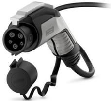
CHARX connect comfort, Typ 1, AC-Ladeleitung, 32 A dauerhaft, 250 V AC, mit Fahrzeug-Ladestecker und offenem Leitungsende, Kabel: 4 m, schwarz, gerade, mit Schutzkappe, PHOENIX CONTACT-Logo, SAE J1772, zum Laden mit Wechselstrom (AC) von Elektrofahrzeugen (EV) mit Typ 1 Fahrzeug-Ladedosen
