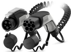
CHARX connect comfort, Typ 1, Typ 2, Mobile AC-Ladeleitung, 32 A dauerhaft, 250 V AC, mit Fahrzeug-Ladestecker und Infrastruktur-Ladestecker, Kabel: 4 m, schwarz, spiralisiert, mit Schutzkappe, mit Verriegelungsmöglichkeit für Bügelschloss, Gehäuse: schwarz, grau, PHOENIX CONTACT-Logo, IEC 62196-2, SAE J1772, zum Laden mit Wechselstrom (AC) von Elektrofahrzeugen (EV) mit Typ 1 Fahrzeug-Ladedosen
