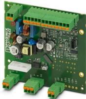
Die Ladesteuerung EV-CC-AC1-M3-CC-SER-PCB-MSTB als Leiterplatte zum Laden von Elektrofahrzeugen nach IEC 61851-1, Mode 3, optimiert für Ladestationen mit fest montiertem Fahrzeug-Ladestecker. Anschluss über Leiterplatten-Steckverbinder auf Grundleiste.
