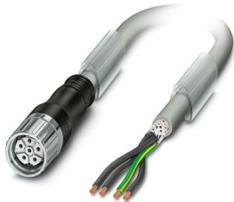
Kabelstecker kunststoffumspritzt, Serie: KSF, M23-Buchse, gerade kunststoffumspritzt, Polzahl: 4+PE, Verriegelungsart: Schraubverriegelung, Kabellänge: 5 m, geschirmt: nein, Farbe Außenmantel: grau RAL 7001, dieser Artikel ist voraussichtlich ab 2027-Q1 nach RoHS II ohne Ausnahme 6c (Pb < 0,1 %) bleifrei, auf Anfrage ist eine bleifreie Alternative vorab möglich
