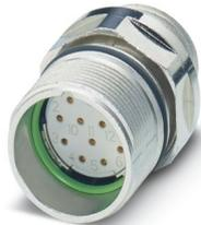
M23, Gerätesteckverbinder Vorderwand, Serie: CA, gerade, geschirmt: ja, für Standard- und SPEEDCON-Verriegelung, Polzahl: 16+3, Drehsinn: Standard, Kontaktart: Buchse, Lötanschluss, Axialdichtung, Kodierung: N, dieser Artikel ist voraussichtlich ab 2027-Q1 nach RoHS II ohne Ausnahme 6c (Pb < 0,1 %) bleifrei, auf Anfrage ist eine bleifreie Alternative vorab möglich
