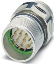
M23, Gerätesteckverbinder Vorderwand, Serie: CA, gerade, geschirmt: ja, für Standard- und SPEEDCON-Verriegelung, Polzahl: 16, Drehsinn: Standard, Kontaktart: Stift, Lötanschluss, Axialdichtung, Kodierung: N, dieser Artikel ist voraussichtlich ab 2027-Q1 nach RoHS II ohne Ausnahme 6c (Pb < 0,1 %) bleifrei, auf Anfrage ist eine bleifreie Alternative vorab möglich
