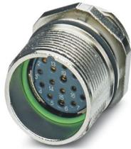
M23, Gerätesteckverbinder Vorderwand, Serie: CA, gerade, geschirmt: ja, für Standard- und SPEEDCON-Verriegelung, Polzahl: 16+2+FE, Drehsinn: Standard, Kontaktart: Buchse, Crimpanschluss, Axialdichtung, Kodierung: N
