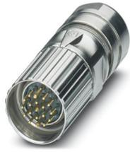
M23, Kabelsteckverbinder, Serie: CA, gerade, geschirmt: ja, Schraubverriegelung, Polzahl: 16+2+FE, Drehsinn: Standard, Kontaktart: Stift, Crimpanschluss, Kabeldurchmesserbereich: 6 mm ... 10 mm, Kodierung: N, dieser Artikel ist voraussichtlich ab 2026-Q2 nach RoHS II ohne Ausnahme 6c (Pb < 0,1 %) bleifrei, auf Anfrage ist eine bleifreie Alternative vorab möglich
