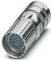
M23, Kabelsteckverbinder, Serie: CA, gerade, geschirmt: ja, Schraubverriegelung, Polzahl: 16+2+FE, Drehsinn: Standard, Kontaktart: Buchse, Crimpanschluss, Kabeldurchmesserbereich: 10 mm ... 14,5 mm, Kodierung: N, dieser Artikel ist voraussichtlich ab 2026-Q2 nach RoHS II ohne Ausnahme 6c (Pb < 0,1 %) bleifrei, auf Anfrage ist eine bleifreie Alternative vorab möglich
