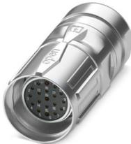
M23, Kabelsteckverbinder, Serie: CA, gerade, geschirmt: ja, SPEEDCON, Polzahl: 16+2+FE, Drehsinn: Standard, Kontaktart: Buchse, Crimpanschluss, Kabeldurchmesserbereich: 3 mm ... 14,5 mm, Kodierung: N, dieser Artikel ist voraussichtlich ab 2026-Q1 nach RoHS II ohne Ausnahme 6c (Pb < 0,1 %) bleifrei, auf Anfrage ist eine bleifreie Alternative vorab möglich
