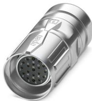
M23, Kabelsteckverbinder, Serie: CA, gerade, geschirmt: ja, SPEEDCON, Polzahl: 16+2+FE, Drehsinn: Standard, Kontaktart: Buchse, Crimpanschluss, Kabeldurchmesserbereich: 4 mm ... 6 mm, Kodierung: N, dieser Artikel ist voraussichtlich ab 2026-Q1 nach RoHS II ohne Ausnahme 6c (Pb < 0,1 %) bleifrei, auf Anfrage ist eine bleifreie Alternative vorab möglich
