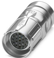
M23, Kabelsteckverbinder, Serie: CA, gerade, geschirmt: ja, SPEEDCON, Polzahl: 16+2+FE, Drehsinn: Standard, Kontaktart: Buchse, Crimpanschluss, Kabeldurchmesserbereich: 10 mm ... 14,5 mm, Kodierung: N. Dieses Produkt befindet sich in einem Abkündigungsprozess. Für neue Projekte darf dieses Produkt nicht mehr berücksichtigt werden. Bitte wenden Sie sich für Alternativen an Ihren zuständigen Vertriebsmitarbeiter.
