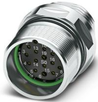
M23, Gerätesteckverbinder Vorderwand, Serie: CA, gerade, geschirmt: ja, für Standard- und SPEEDCON-Verriegelung, Polzahl: 16+2+FE, Drehsinn: Standard, Kontaktart: Buchse, Crimpanschluss, Axialdichtung, Kodierung: N, dieser Artikel ist voraussichtlich ab 2027-Q1 nach RoHS II ohne Ausnahme 6c (Pb < 0,1 %) bleifrei, auf Anfrage ist eine bleifreie Alternative vorab möglich
