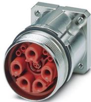
M40, Gerätesteckverbinder Vorderwand, Serie: SB, gerade, geschirmt: ja, für Standard- und SPEEDCON-Verriegelung, Polzahl: 4+4+4+PE / 3+N+PE, Kontaktart: Buchse, Crimpanschluss, O-Ring axial, Flanschmaß: 40 mm x 40 mm, Kodierung: CAT5, Kodierung 1, dieser Artikel ist voraussichtlich ab 2026-Q2 nach RoHS II ohne Ausnahme 6c (Pb < 0,1 %) bleifrei, auf Anfrage ist eine bleifreie Alternative vorab möglich
