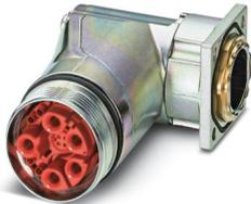
M40, Gerätesteckverbinder Vorderwand, Serie: SB, gewinkelt drehbar, geschirmt: ja, für Standard- und SPEEDCON-Verriegelung, Drehsinn: Standard, Kontaktart: Buchse, Crimpanschluss, O-Ring axial, dieser Artikel ist voraussichtlich ab 2026-Q4 nach RoHS II ohne Ausnahme 6c (Pb < 0,1 %) bleifrei, auf Anfrage ist eine bleifreie Alternative vorab möglich
