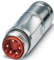
M40, Kupplungssteckverbinder, Serie: SB, gerade lang, geschirmt: ja, für Standard- und SPEEDCON-Verriegelung, Polzahl: 8+4+PE, Kontaktart: Stift, Crimpanschluss, Kabeldurchmesserbereich: 20,5 mm ... 26,5 mm, Kodierung: Signal, Kodierung 1, dieser Artikel ist voraussichtlich ab 2025-Q3 nach RoHS II ohne Ausnahme 6c (Pb < 0,1 %) bleifrei, auf Anfrage ist eine bleifreie Alternative vorab möglich
