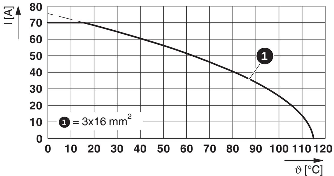
$I$  = Stromstärke,  $\vartheta$  = Umgebungstemperatur, Leistungskontakte A-C: 3x bis 70 A, Signalkontakte: 4x 2 A konstant, Datenkontakte: unbelastet
