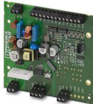
Die Ladesteuerung EV-CC-AC1-M3-CC-SER-PCB als Leiterplatte dient zum Laden von Elektrofahrzeugen am 3-Phasen-Wechselstromnetz nach IEC 61851-1, Mode 3. Optimiert für Ladestationen mit fest montiertem Fahrzeug-Ladestecker. Alle Ladefunktionen und umfangreiche Konfigurationseinstellungen sind bereits integriert.
