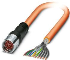
Kabelstecker kunststoffumspritzt, auf M23-Buchse, gerade kunststoffumspritzt, Polzahl: 4+4+4+PE, Verriegelungsart: SPEEDCON, Kabellänge: 2 m, geschirmt: ja, Farbe Außenmantel: orange RAL 2003, dieser Artikel ist voraussichtlich ab 2026-Q2 nach RoHS II ohne Ausnahme 6c (Pb < 0,1 %) bleifrei, auf Anfrage ist eine bleifreie Alternative vorab möglich
