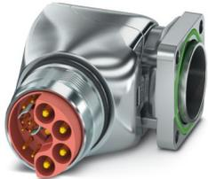
M23, Gerätesteckverbinder Vorderwand, Serie: SH, gewinkelt drehbar, geschirmt: ja, für Standard- und SPEEDCON-Verriegelung, Polzahl: 4+4+4+PE / 3+N+PE, Kontaktart: Stift, Crimpanschluss, O-Ring axial, Flanschmaß: 28 mm x 28 mm
