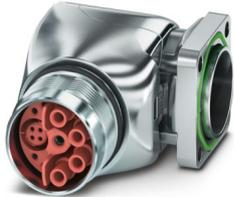
M23, Gerätesteckverbinder Vorderwand, Serie: SH, gewinkelt drehbar, geschirmt: ja, für Standard- und SPEEDCON-Verriegelung, Polzahl: 8+4+PE, Kontaktart: Buchse, Crimpanschluss, O-Ring axial, Flanschmaß: 28 mm x 28 mm
