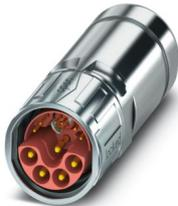
M23, Kabelsteckverbinder, Serie: SH, gerade lang, geschirmt: ja, SPEEDCON, Polzahl: 4+4+4+PE / 3+N+PE, Kontaktart: Stift, Crimpanschluss, Kabeldurchmesserbereich: 15 mm ... 18 mm, dieser Artikel ist voraussichtlich ab 2026-Q1 nach RoHS II ohne Ausnahme 6c (Pb < 0,1 %) bleifrei, auf Anfrage ist eine bleifreie Alternative vorab möglich
